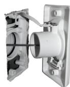
Passez une section de cintre recourbé dans la prise puis dans la plaque de montage. En retenant la plaque de montage avec le cintre recourbé, installez la prise à l'aide des vis fournies avec le kit d'installation. Ne collez pas la prise; un joint d'étanchéité est déjà installé dans la plaque de montage. Si la vis qui est à la hauteur du tuyau semble trop longue et risque de percer le tuyau, utilisez la plus petite des vis fournies avec la prise d'installation.
