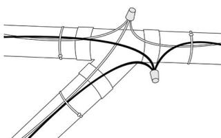
Il est facile de faire suivre le câblage le long des tuyaux et en faisant des connections à chaque intersection de tuyaux. Connectez les fils de même couleur ensemble à l'aide de 2 capuchons-connecteurs. Si tous les fils ont la même couleur, assurez-vous de connecter les fils venant de 3 directions différentes (en provenance des 3 tuyaux). Faites de même avec les 2e fils.
